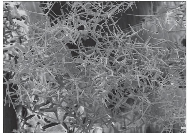
Die Arme der Tetrapoden-Heftklammern verhaken sich ineinander und bilden auf diese Weise einen festen Verbund. Auch hier eine rasterelektronenmikroskopische Aufnahme.
